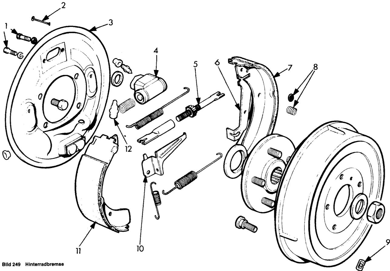
**Bild 249 Hinterradbremse**
