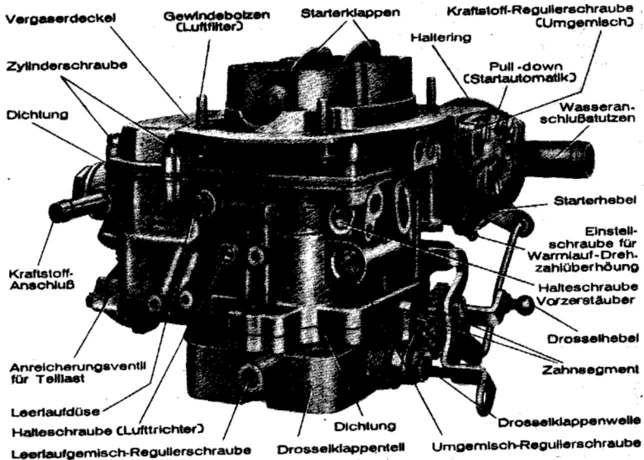
Die deutschen Sechszylindermotoren sind aus Abgasgründen mit dem Zusatzgemisch-Vergaser 32/32 oder 35/35 EEIT ausgerüstet (oft findet man auch die Bezeichnung »Umgemisch-Vergaser«). Die im Bild bezeichnete Leerlaufgemisch-Regulierschraube und die Kraftstoff-Regulierschraube werden nach der Grundeinstellung im Werk mit Verschlußkappen »plombiert«, so daß als einzige Verstellmöglichkeit die Umgemisch-Regulierschraube, die wegen ihrer Größe nicht zu übersehen ist, bleibt.
